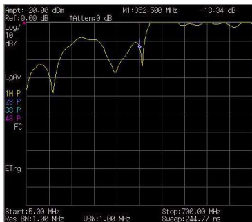
图 22 测量滤波器的回波损耗
